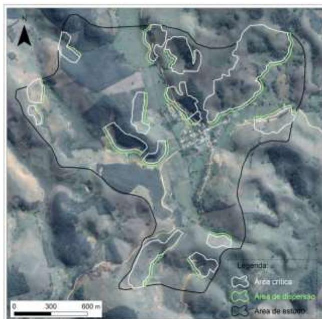
Figura 6 - Exemplo da definição de limites das áreas crítica e de dispersão para um processo de deslizamento planar (CPRM, 2018)
