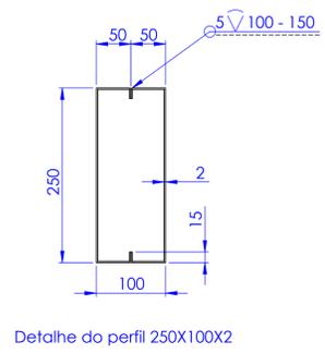
Executando os cortes conforme desenho, os perfis se encaixam, terminando em um ponto central.
